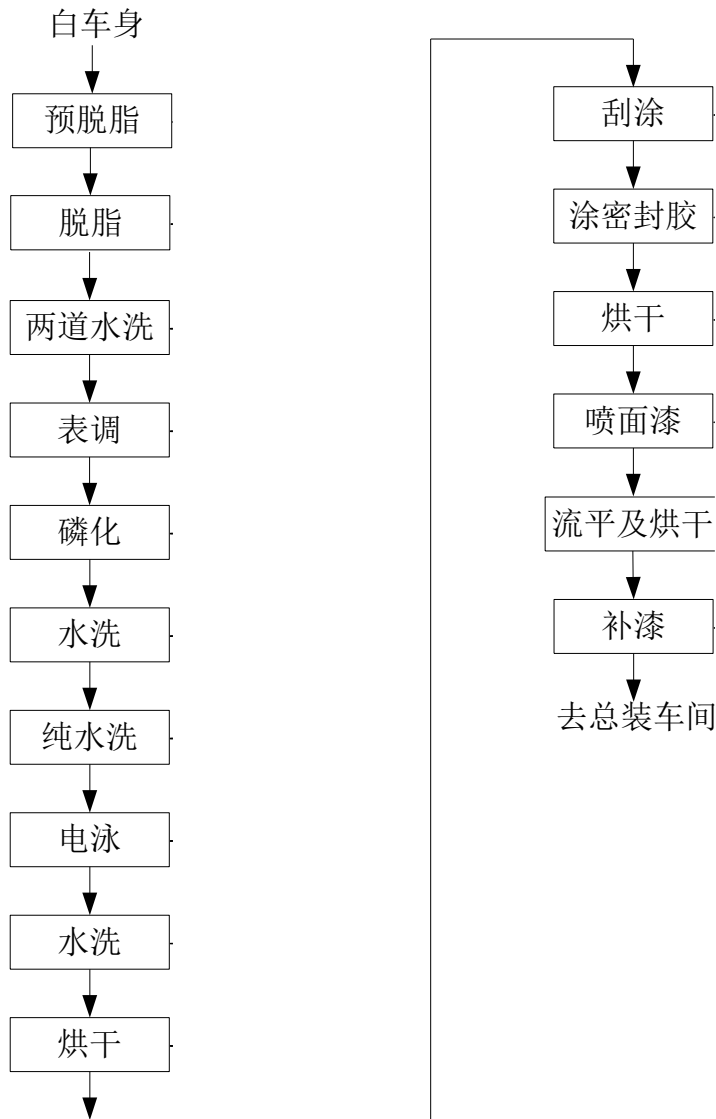
图 3-8 涂装车间生产工艺污染流程
